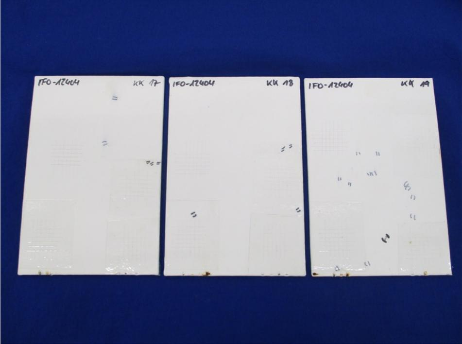
Abbildung 5 – Proben nach 240 Stunden KK-Prüfung
